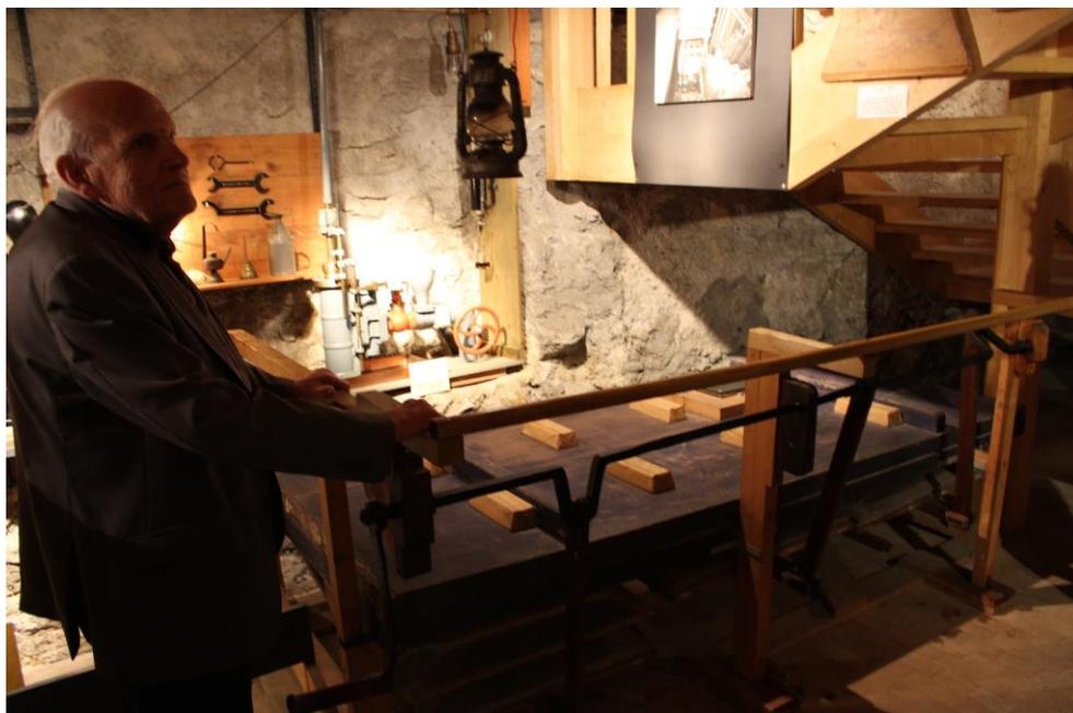
M. Gramm devant l'une des machines actionnant la soufflerie : ici, trois soufflets reliés à un arbre à cames viennent en actionner un quatrième placé au-dessus.
